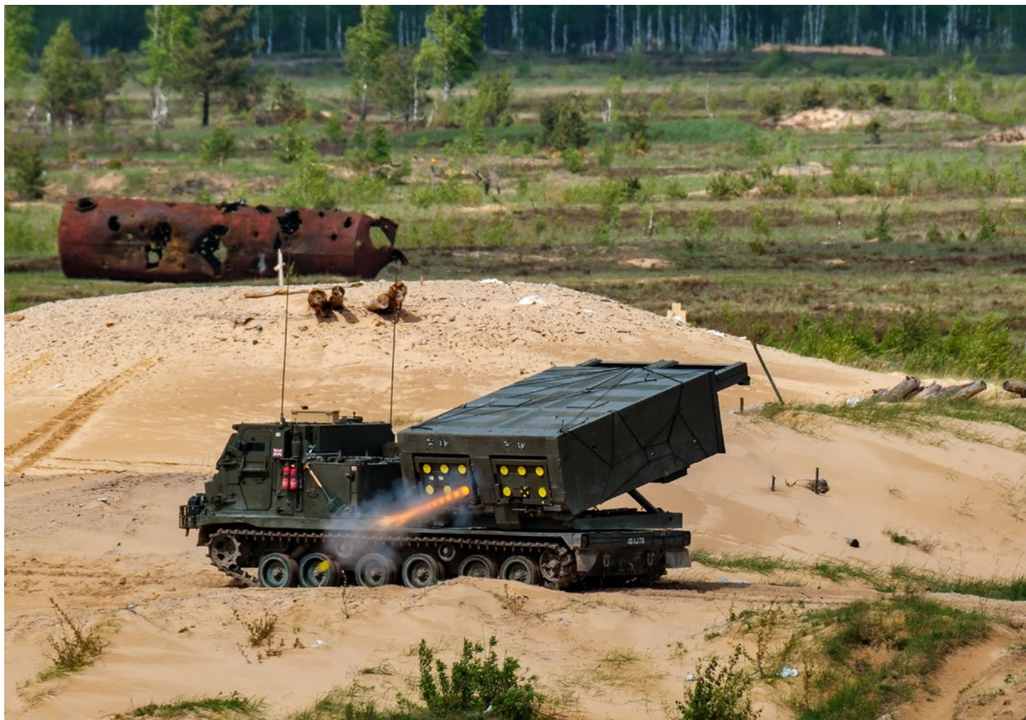
MLRS rakettartillerisystem montert på et beltegående chassis. Kombinasjonen av sensorer og langtrekkende presisjonsild påvirker stridsformene asymmetrisk.
