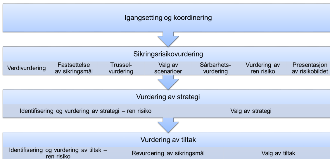
Figur 4.3 Elementer som inngår i prosessen for sikringsrisikoanalyse i henhold til NS5832:2014 (basert på Standard Norge, 2014).
