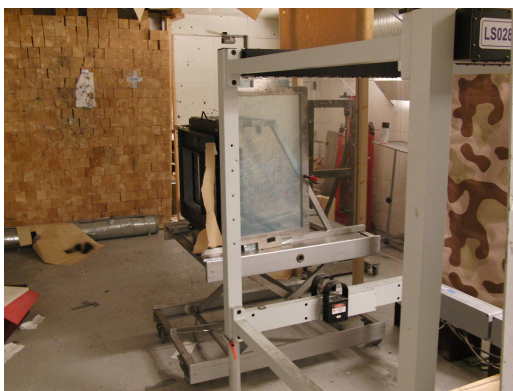
(d) Skin simulant and velocity detector.
