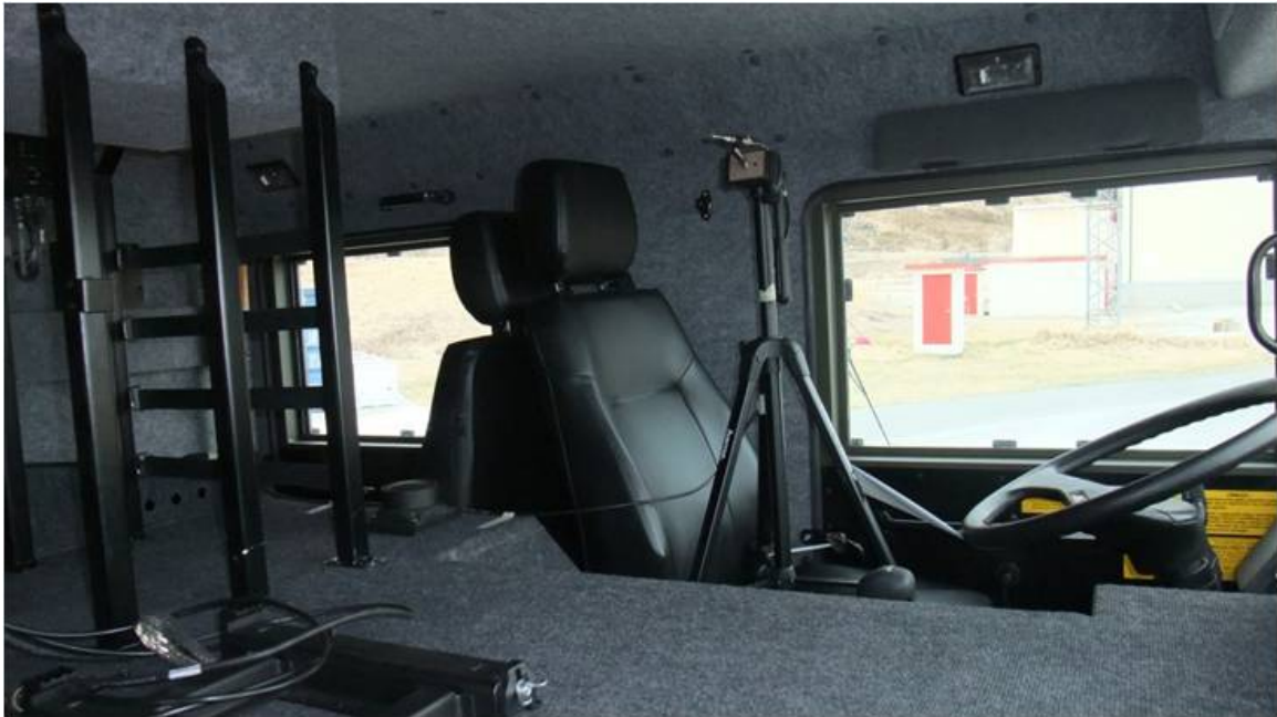
Figur D.5 Avfyring fra lastebil på Andøya. Sensor 1 i hodeposisjon for føreren.
