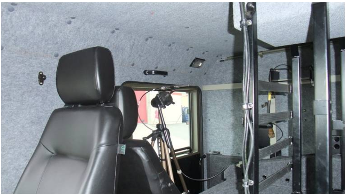
Figur D.6 Avfyring fra lastebil på Andøya. Sensor 2 i hodeposisjon for operatøren.
