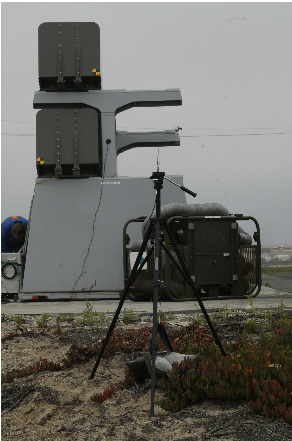
Figur E.8 Avfyring fra fregattrampe i USA. Sensor 3. Som vi ser er mikrofonen orientert med membranet vendt mot missilbanen.
