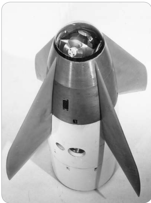
Neseseksjon Penguin Mk 1. Bak glassdommen på toppen ses søkeren. På siden er de styrbare canardfinnerne og lenger nede ses åpningen for laser høydemåler.
