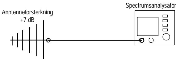
Figur C.1 Måleoppstilling for måling av senderenes effekt
