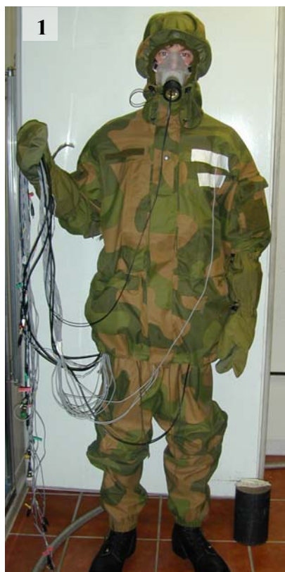
Figur 2-4: Forsøksperson med alt utstyret på, inkludert respirasjonsmaske (1). Forsøksperson på tredemølle i klimakammer, boksen for subjektiv evaluering vises oppe til venstre på veggen (2).
