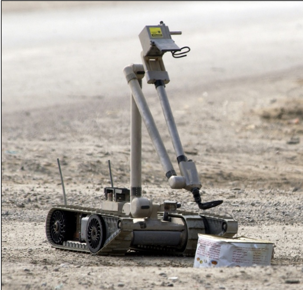
Figur 3.5 PackBot har blitt benyttet i Irak og Afghanistan til blant annet minerydding og klarering av et operasjonsområde før styrker inntar området. Det fins tre ulike konfigurasjoner av PackBot. Figuren viser en PackBot EOD i bruk i Irak
