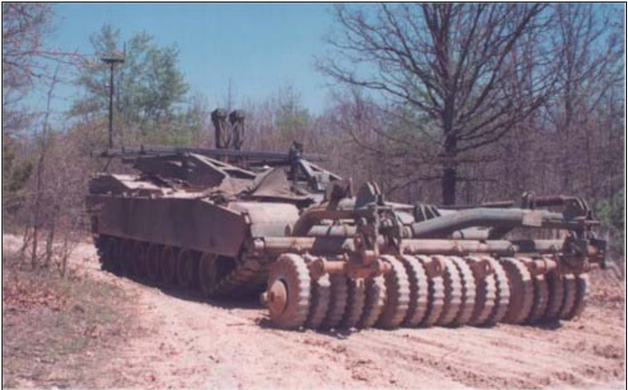
Figur 3.13 M60 Panther er en M60 Patton stridsvogn som er spesialtilpasset til mineryddingsoppdrag. Tårnet er fjernet, og ruller for fjerning av miner er montert i fronten. Den er utstyrt med fjernstyring slik at den kan opereres fra trygg distanse til minefeltet
