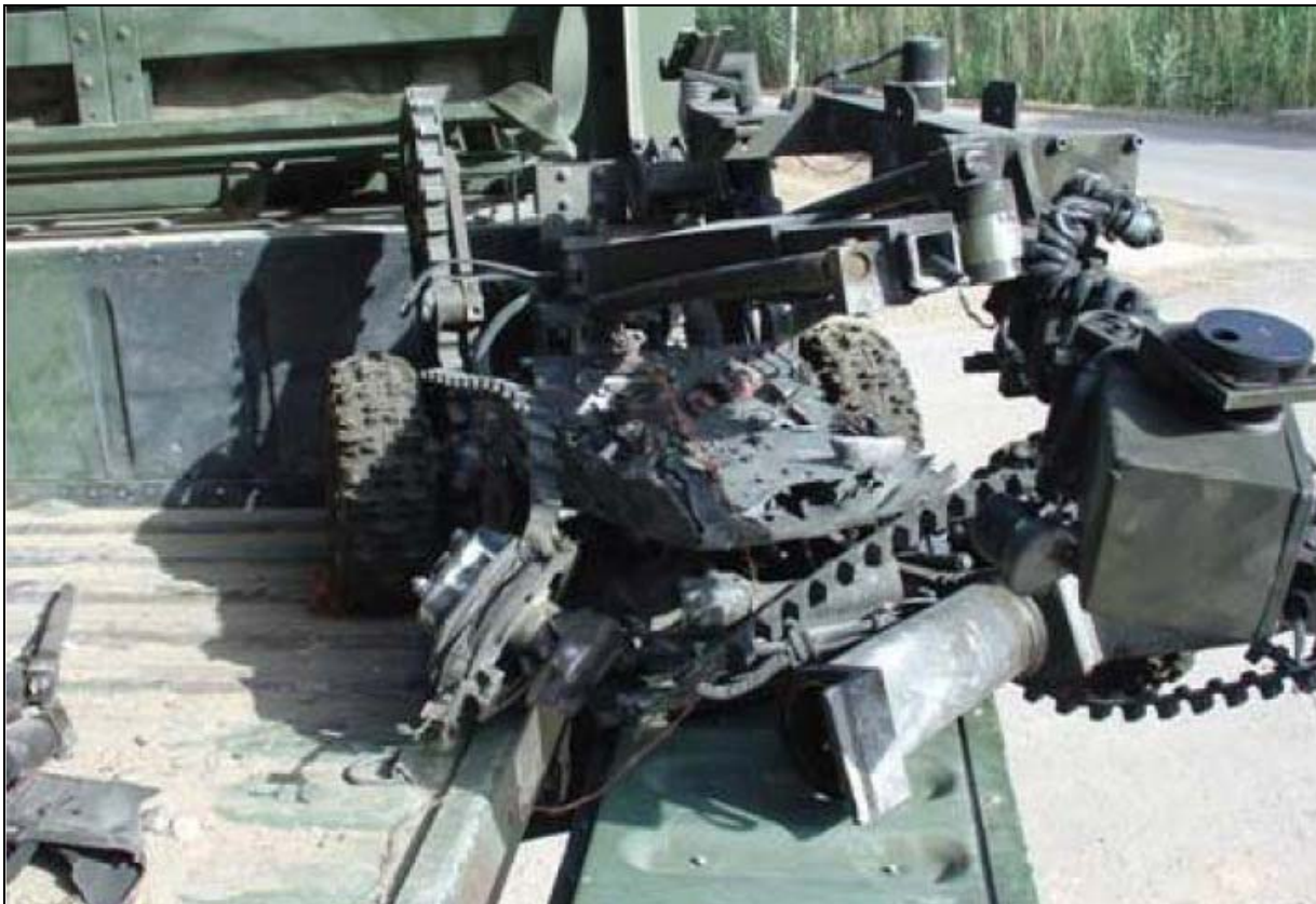
Figur 5.1 Dette ubemannede bakkekjøretøyet ble ødelagt under rydding av eksplosiver i Irak. Ingen personer kom til skade
