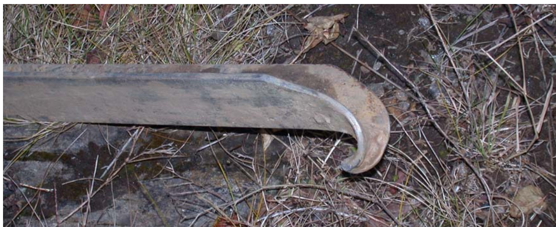
Figur 5.1 Slik kan bardunfestene se ut ved steinete grunn og en kraftig sleggefører. Dette er bunnen på festet (av vinkeljern), som engang i tiden var spiss.
