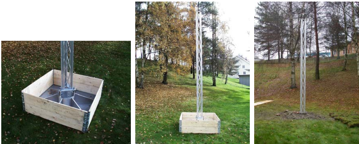
Figur 2.1 Kameramast basert på fagverksmast. Bildet til venstre viser foten til masta, bildet til venstre viser hele masta, og bildet til høyre viser masta der aluminiumsfoten er gravd ned i bakken.
