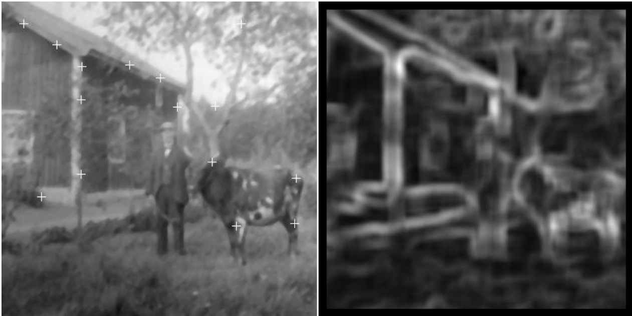
Figur 3.4 Bildet KOSSA (medianfiltrert) overlagret senterpunktene for de 15 (antatt) beste matcheområdene sammen med det korresponderende utvelgelsesbildet (som i dette tilfellet er identisk med inhomogenitetsbildet). Vindusstørrelsen som er benyttet i beregningen av inhomogenitetsbildet er 21 \times 21 piksler. Inhomogenitetsbildet er normalisert for å utnytte det tilgjengelige dynamiske området.
