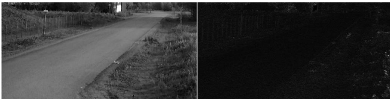
Figur 3.3 Det første bildet i sekvensen 8.1 fra sekvensserien host97 (medianfiltrert) sammen med det korresponderende standardavviksbildet. Det sistnevnte bildet er generert på bakgrunn av de 20 første bildene i sekvensen, og det er normalisert for å utnytte det tilgjengelige dynamiske området. Som vi ser er tilnærmet hele bildet stasjonært. Det er bare noe av vegetasjonen i høyre bildekant som har beveget seg.
