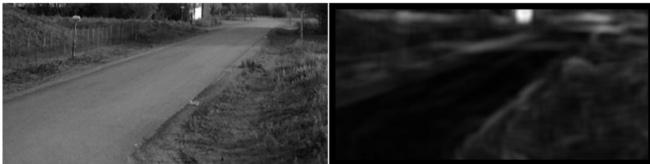
Figur 3.2 Det første bildet i sekvensen 8.1 fra sekvensserien host97 (medianfiltrert) sammen med det korresponderende inhomogenitetsbildet. Vindusstørrelsen som er benyttet i beregningen av inhomogenitetsbildet er 21 \times 21 piksler. Inhomogenitetsbildet er normalisert for å utnytte det tilgjengelige dynamiske området.
