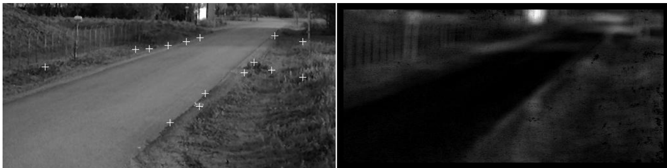
Figur 3.5 Det første bildet i sekvensen 8.1 fra sekvensserien host97 (medianfiltrert) overlappet senterpunktene for de 15 (antatt) beste matcheområdene sammen med det korresponderende utvelgelsesbildet. Utvelgelsesbildet er normalisert for å utnytte det tilgjengelige dynamiske området.
