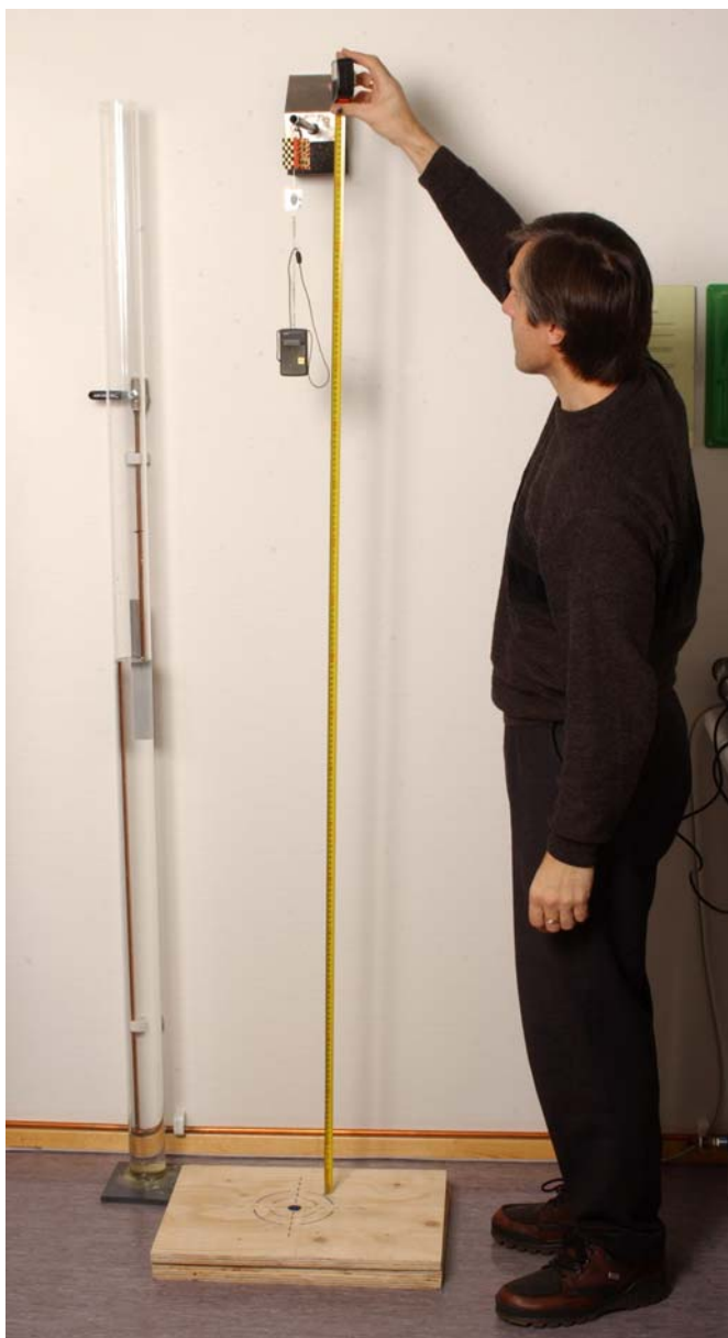
Figur 3.1 Til høyre forsøksoppsett for støtbelastning ved fall fra høyde på 150 cm. Til venstre ses perspexrøret fylt med vann til en høyde av 100 cm som prøvene ble senket ned i.
