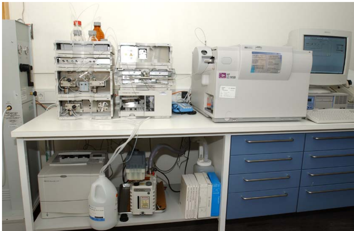
Figur 1.1 Bordmodell væskechromatograf tilkoblet atmospheric pressure ionization elektropray massespektrometer (HPLC-API-ES-MS)
