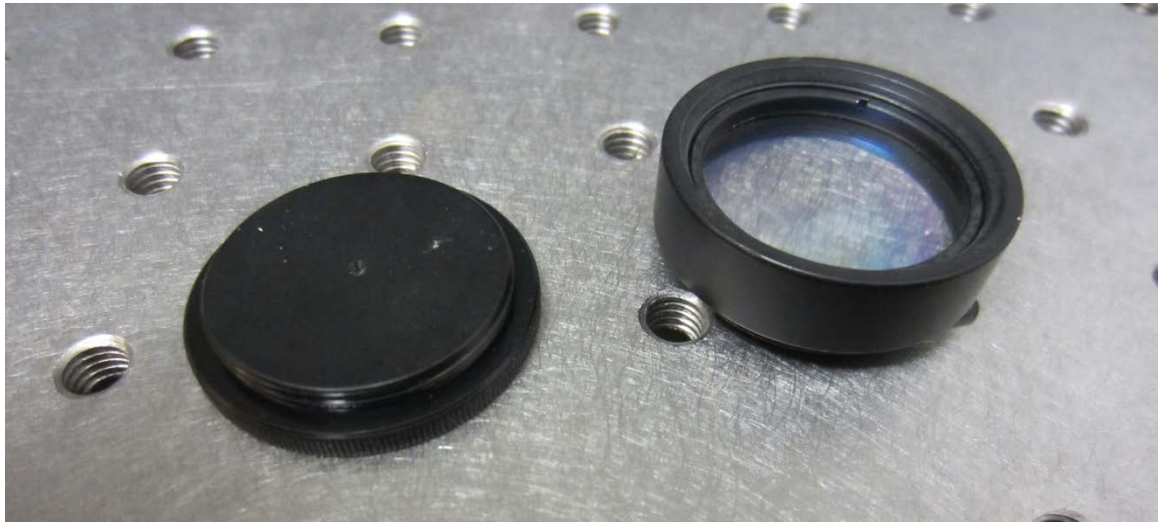
Figur 3.3 Deksel for blokkering av laserstrålen og typisk filter for demping av laserstrålen.
