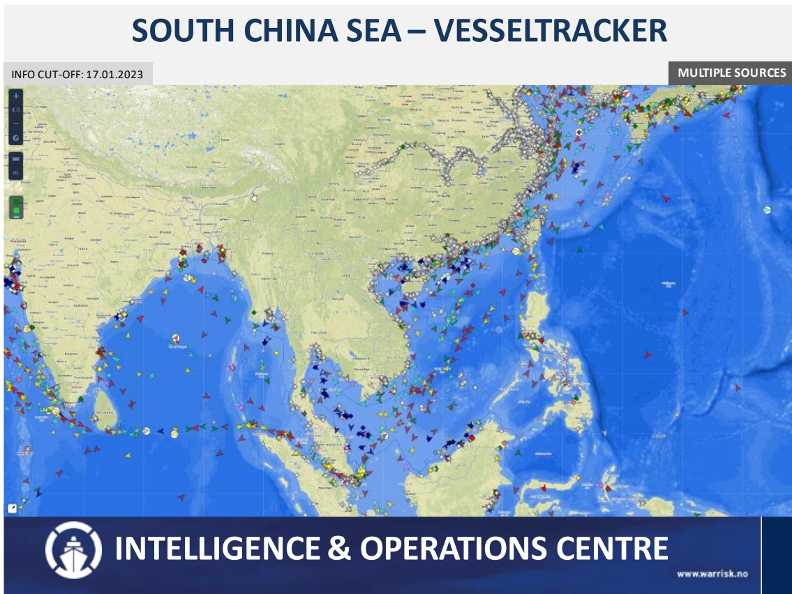
Figur 6.2 Oversiktsbilde tatt 17. januar 2023 over skipstrafikken i området og hvilke seilingsruter den bruker. Bildet viser skip som bruker Automatic Identification System (AIS), der fargene uttrykker ulike typer fartøy. Eksempelvis er grønt kargoskip, rødt bulk carrier og gult er olje- og kjemikalietanker. Illustrasjon og kilde: Den norske krigsforsikring for skip, 2023.
